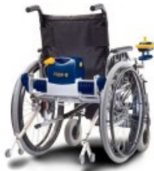
Aandrijffunit met twee motoren achteraan op de rolstoel
