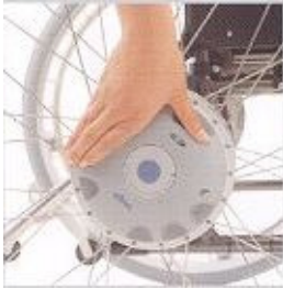
Elektromotoren in de wielnaven
