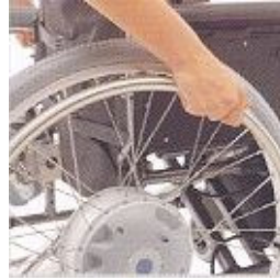
Elektromotoren in de wielnaven
