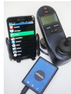
Androidsmartphone + Housemate 5 switch (IR-zender + app) + interface naar rolstoelbesturing
