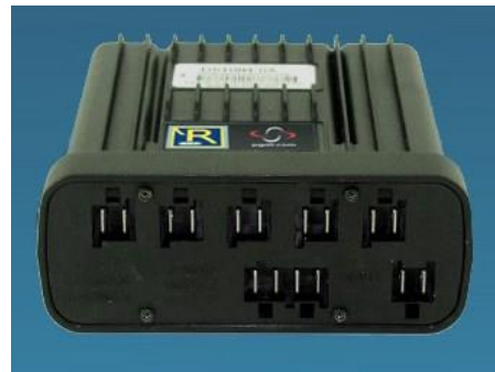
PG Rnet Input /output module
