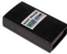
Easy Mouse Permobil: IR-ontvanger om de muis te sturen via IR-zender in rolstoelbesturing
