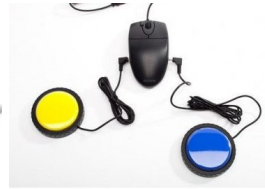
vb. twee eenfunctieschakelaars op muis, voorzien van aansluiting voor externe schakelaars
